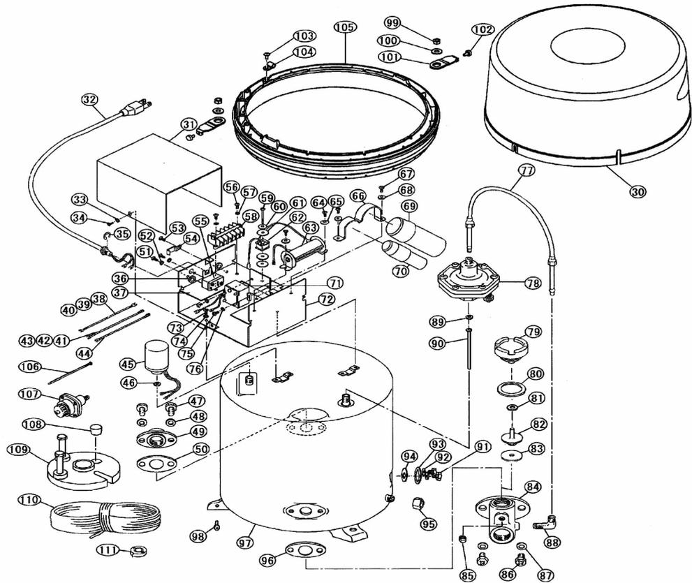
深井戸用圧力タンク式多段タービン水中ポンプ（HP-T-F形 200～600W 単相）
